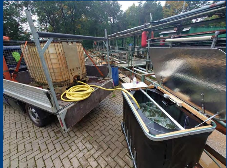
*Befüllung des Fällungsreaktors in Ibbenbüren mit Grubenwasser aus dem Dickenberger Stollen*
