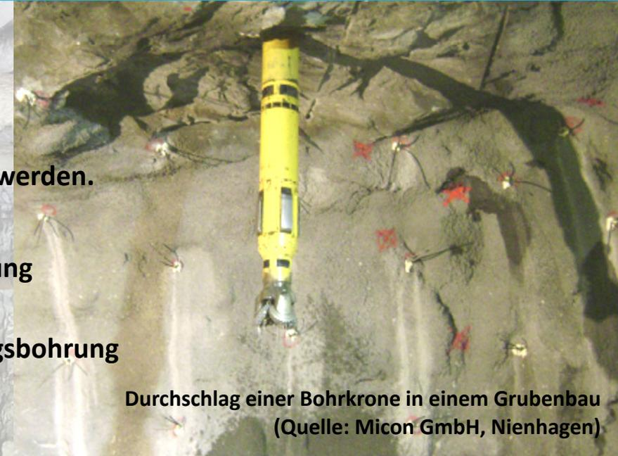
Durchschlag einer Bohrkronen in einem Grubenbau
